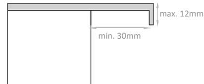
Die Klemmverbindung wird immer zwischen Ober- und Unterseite der Fensterbank hergestellt, NICHT mit der Regennase.
