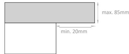
Kein Winkel-Adapter bei rechtwinkeligem Querschnitt nötig
