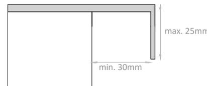
Bei längerer Regennase wird der Winkeladapter mit dem langen Schenkel nach oben eingebaut werden.
